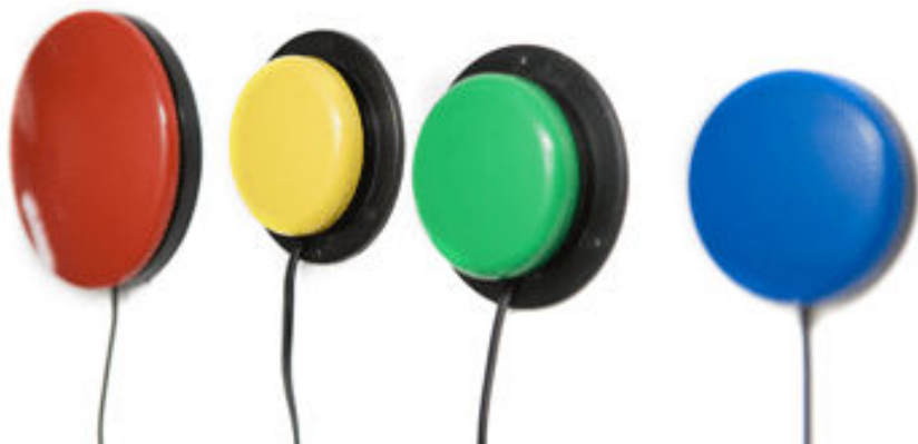
Figur 2. Brytarkontakter i olika färger. Genom att trycka på en brytare kan olika händelser styras. I musikaliska sammanhang styr musikanten olika ackord eller toner som finns exempelvis på en synthesizer eller i en dator.
