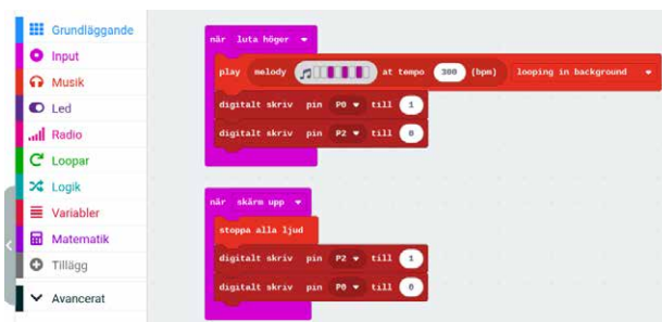
Bild 9: Exempel på programmering av ljud- och ljussignaler
